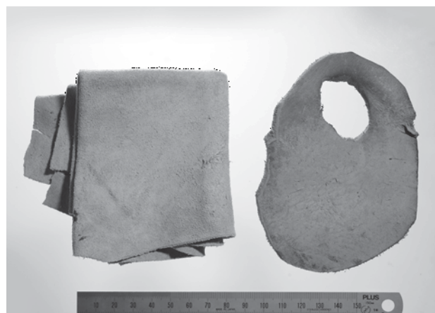
図 14 掌を保護するための革布 (左：30cm 大の革布を、4つ折りに畳んだもの、右：親指を通すための孔を穿ったもの)
