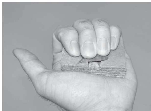
図 18 固定パッドを使った際の保持の仕方
