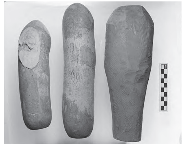
写真9 ツゲ製ハンマー (右から 1.1 kg、715g、510g)
