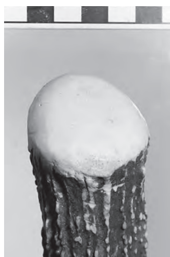
写真 14 有機質製ハンマーの機能部 (使用時でも、つねに丸く仕上げるメンテナンスを行う)
