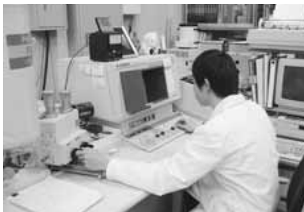
Photo.5 走査型電子顕微鏡(SEM)による観察・同定
